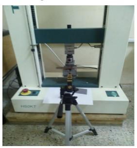
Fig (3): The V-bending test
