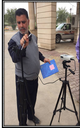
صور (2) المسح الميداني للإشعاع الشمسي المباشر و المنتشر. باستعمال جهاز - Solar power meter SPM – 1116 SD .
