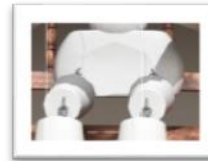
شكل (٥٦) الحوض مع الساقين بعد إضافة عجينة السيراميك والتشطيب النهائي والدهان والتنعيم وتركيب المفصلات وتثبيت الخيط
